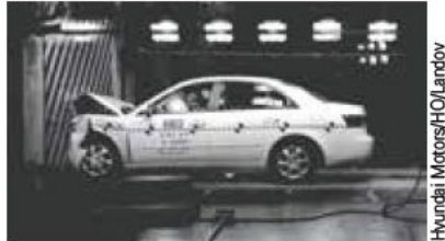
Figura 8.6 (Exemplo 8.4) (a) O momento desse carro muda por causa do choque contra o muro. (b) Em um teste de colisão, a maior parte da energia cinética inicial do carro é transformada em energia associada ao dano no carro.
